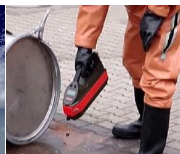
GDA 2 draagbare meter voor snelle detectie van gevaarlijke gassen
