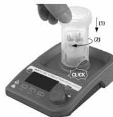
Wenn diese Vorgehensweise nicht befolgt wird, kann ein sicherer Betrieb nicht gewährleistet werden und das Gerät kann beschädigt werden.
