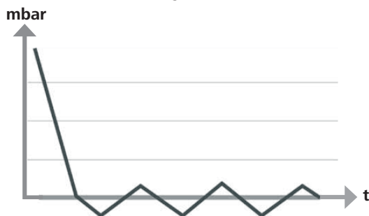
Schematische Darstellung einer Zwei-Punkt-Vakuumregelung
