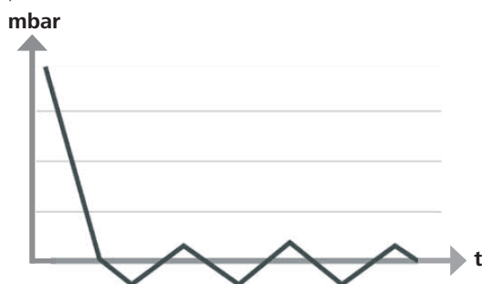
Rappresentazione schematica di una regolazione del vuoto a due punti
