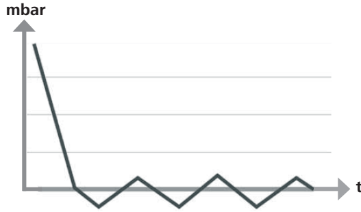
İki pozisyonlu vakum kontrolünün şematik görünümü
