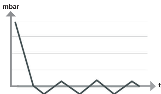
Схема двухпозиционного регулирования вакуума
