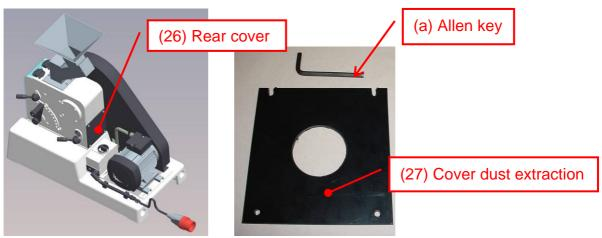
Der Labor-Backenbrecher wird ohne Absaugöffnung ausgeliefert. Um eine Staubabsaugvorrichtung benutzen zu können, muss die rear cover (26) durch eine spezielle cover dust extraction (27) ersetzt werden.
