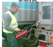
GDA2 meter voor detectie van gevaarlijke gassen
