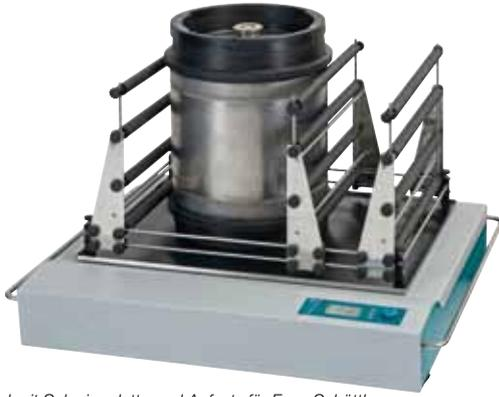
VKS 75 F control mit Schwingplatte und Aufsatz für Fass-Schüttler
