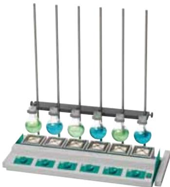
IRB 6 mit Stativgestell, PVC-Schiene und Halteklammern
