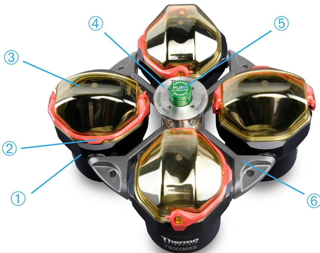
① Beker; ② Kapvergrendeling; ③ Bekerkap; ④ Rotorknop; ⑤ Auto-Lock-toets; ⑥ Rotorkruis
